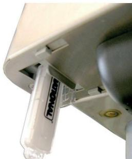
Подключить USB флэш-карту 87.01.275 к USB-порту расположенному слева в нижней части передней панели.
