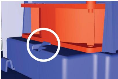
Чтобы снять вентилятор охлаждения, приподнимите его над защелкой корпуса вентилятора.
