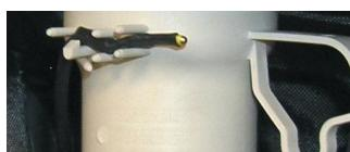
Оба вентилятора охлаждения имеют температурный датчик (NTC). Этот датчик измеряет температуру в месте расположения клапана Y5. Скорость вентилятора охлаждения повышается при повышении температуры.
